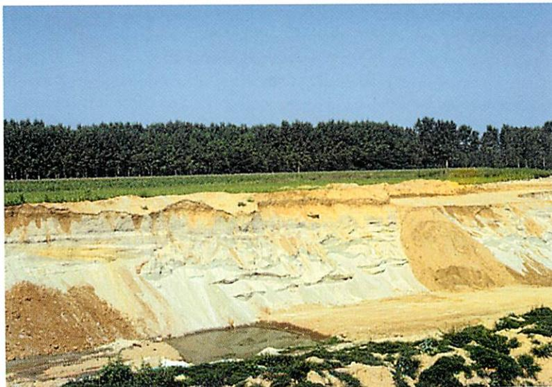
Foto 1 - Esempio di escavazione di sabbia e ghiaia in asciutto mediante arretramento di terrazzo morfologico con restituzione finale dell'area all'uso agricolo.
