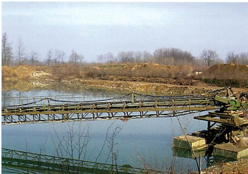
Foto 3 - Il redinger è un impianto utilizzato per l'estrazione di sostanze minerali di cava incoerenti sottofalda. Il nastro trasportatore, terminante con una benna che provvede idraulicamente a portare in superficie il materiale, può essere spostato in ogni settore del giacimento.
